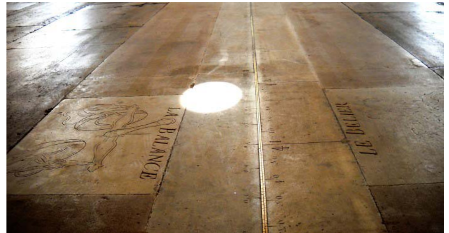
Ligne méridienne de Cassini, Observatoire de Paris, 1732 - détail de la projection sur la ligne
